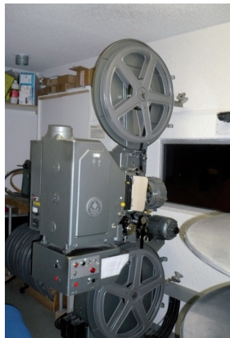
La cabine en 1999 avec le projecteur 35 mm Cinemeccanica et le dérouleur à plateaux au premier plan.
